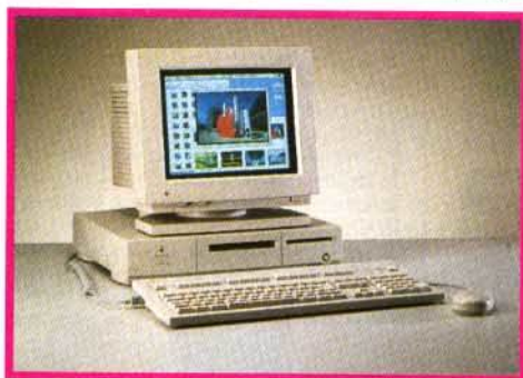
Avec le Centris 610 on entre dans le monde haut de gamme. 68040 à 25 MHz, écran 14", disque dur 230 Mo et CD-ROM intégré en font un excellent outil de travail... et une bête de jeu !
